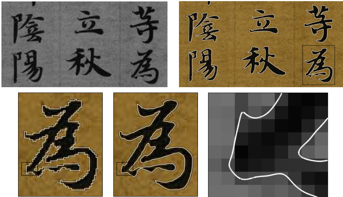
Abb. 5 Oben: Segmentierung verschiedener chinesischer Zeichen. Unten: Vergleich zwischen pixelgenauer und subpixelgenauer Segmentierung. Der Ausschnitt zeigt die Überlegenheit der letzteren.
