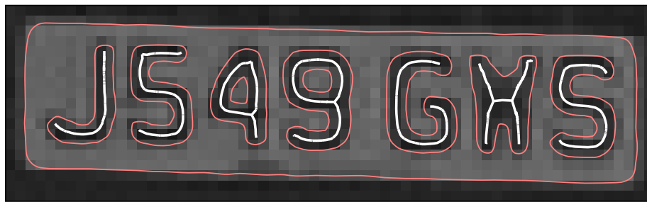
(d) light red : contours (after relevance filtering), white : pruned CAT skeletons
