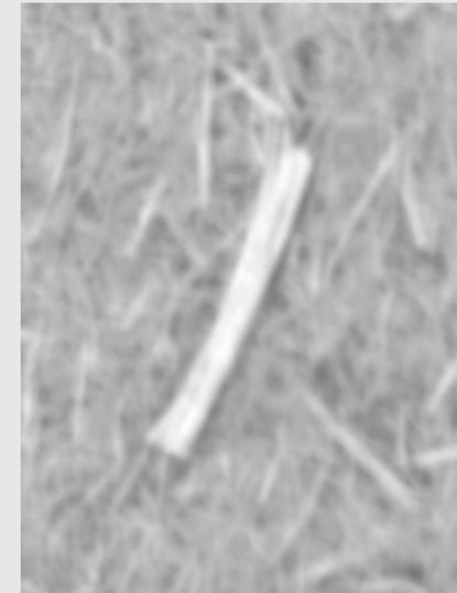
Jedes Merkmal kann in verschiedene Größenklassen unterteilt werden. Als Ergebnis steht die Anzahl der Shives je Flächeneinheit je Größenklasse zur Verfügung.
