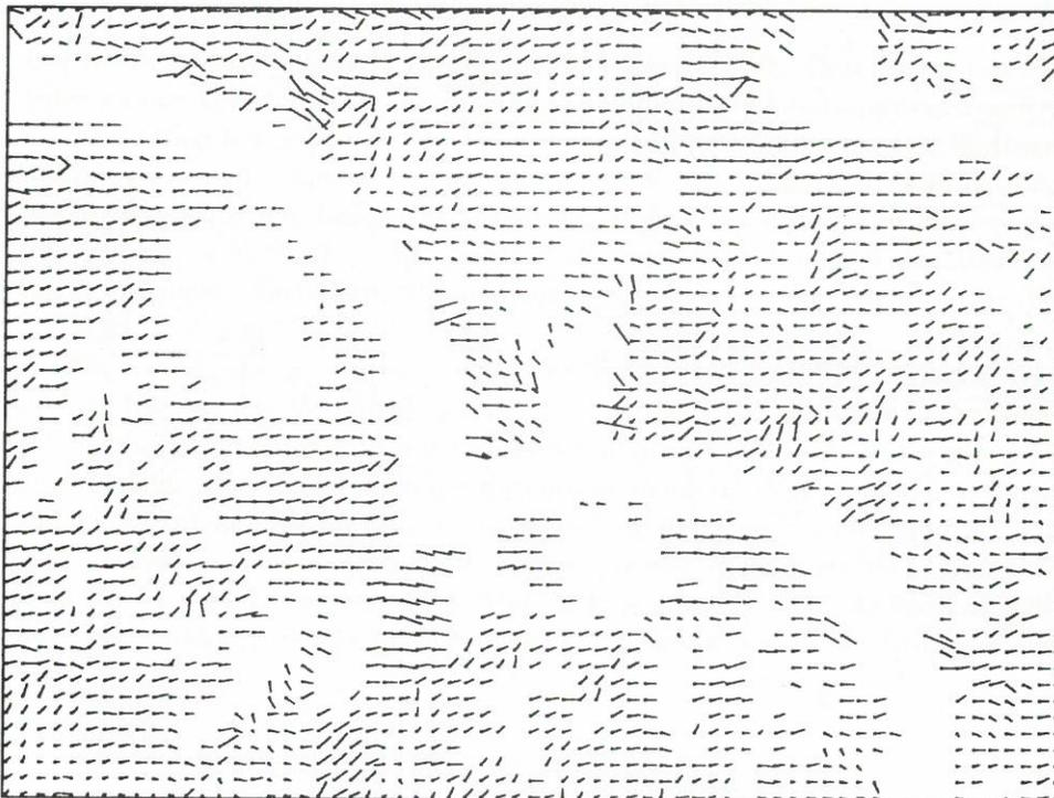
**Abbildung 6.6:** Verschiebungsvektoren von Bild 2 nach Bild 3, berechnet mit kombiniertem Verfahren innerhalb einer  $3 \times 3$  Umgebung.
