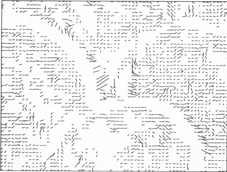
**Abbildung 6.5:** Verschiebungsvektoren von Bild 2 nach Bild 3, berechnet auf dem Intensitätsbild innerhalb einer  $3 \times 3$ -Umgebung.
