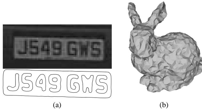
Abbildung 6: (a) 2D-Kantenrekonstruktion aus Canny-Kantenpunkten und (b) 3D-Rekonstruktion aus verrauschten Oberflächenabstapunkten mit Hilfe von  $(\alpha, \beta)$ -shapes.
