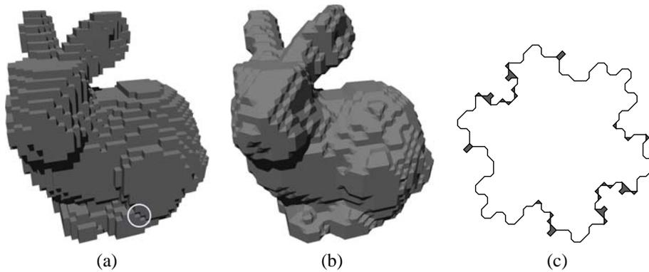
Abbildung 5: Rekonstruktion eines mit einem kubischen Gitter abgetasteten CT-Datensatzes des Stanford Bunnys durch Vereinigung der Voxel (a) und mit Hilfe des *Marching Cubes* Algorithmus (b), sowie Rekonstruktion einer mit einem Quadratgitter abgetasteten Koch-Schneeflocke mit Hilfe von  $\alpha$ -shapes (c).
